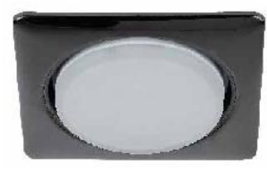
KL71 ↔ 107x107мм ↓ 20 мм 90 мм GX53, 220 В, 12 Вт / GX53 SC • WH • BK • SN • SB
